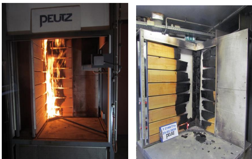
Figuur 29, proefopstelling lariks hout, tijdens en na brandtest (horizontale wandbekleding)
