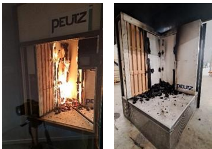
Figuur 28, proefopstelling larikshout tijdens en na brandtest (verticale wandbekleding)
