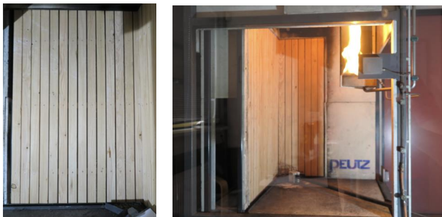
Figuur 27, proefopstelling lariks hout bij start brandtest (verticale wandbekleding)
