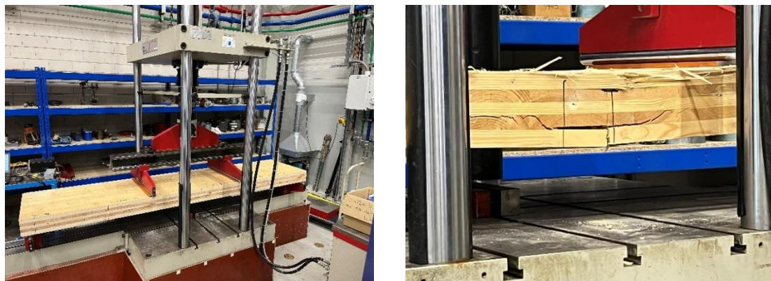
Figuur 40, Test set-up en buigtest CLT-platen
