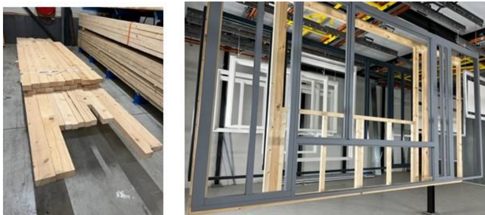
Figuur 32, productie HSB voorzetgevel in de fabriek
