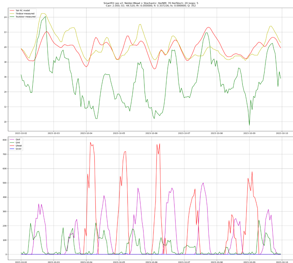
Figuur 14: Voorbeeld 2 gemeten data en gefit model. In de bovenste grafiek zijn weer de gemeten buitentemperatuur (groen) en binnentemperatuur (geel) gegeven samen met het gefitte model berekende binnentemperatuur (rood). Te zien is dat de gemeten binnentemperatuur (geel) en de met het model berekende binnentemperatuur (rood) minder goed overeenkomen dan bij de vorige (vakantie). Dat het minder goed overeenkomt is wel te verwachten omdat er veel onbekende factoren in het spel zijn zoals het openen van binnen en buitendeuren, het aantal aanwezige personen, de beschaduwing van omliggende bomen en het gebruik van raamluiken. Daarnaast volgt de met het model berekende binnentemperatuur de trend van de gemeten binnentemperatuur.
