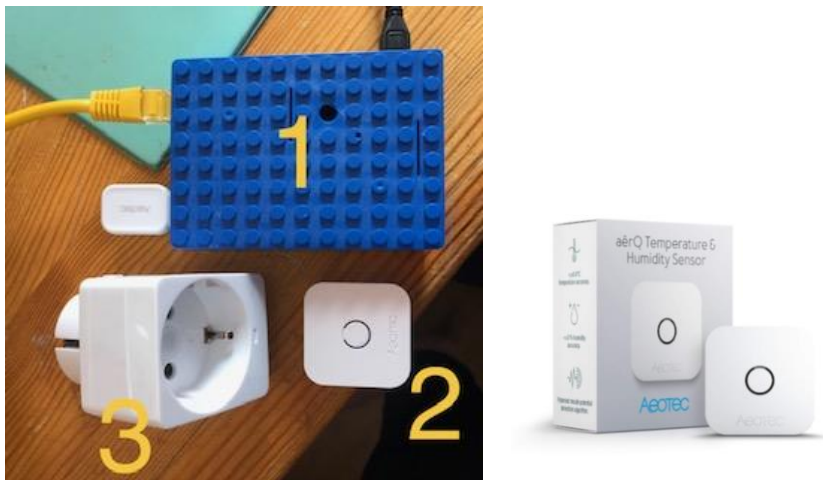
Figuur 2abc: Cloud monitoring system met 1) meetunit 2) draadloze temperatuur-vochtsensoren en 3) smartplugs
