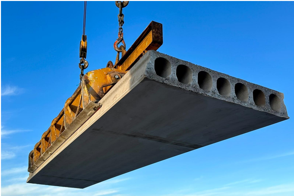
Verplaatsen van kanaalplaatvloer uit nieuw emissie-arm betonmengsel met gecalcineerde klei tijdens fabriekstrial bij VBI
