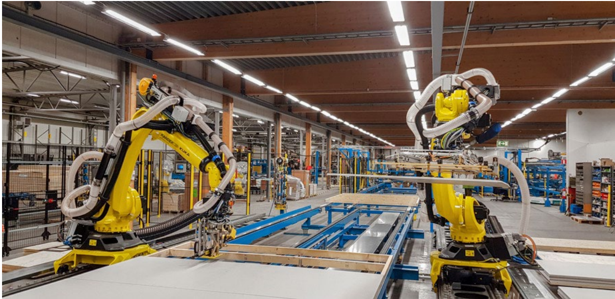
Figuur 5: Randek ZeroLabor productiestation voor houtskeletbouw elementen 6
